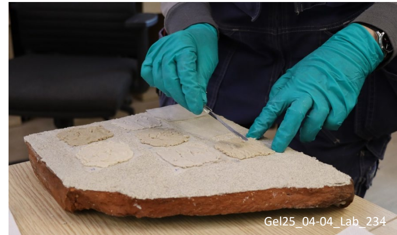
ზემოთ: საფენის აპლიკაცია კირის ბაზაზე დაშლადებული ხსნარის რეპლიკაზე
