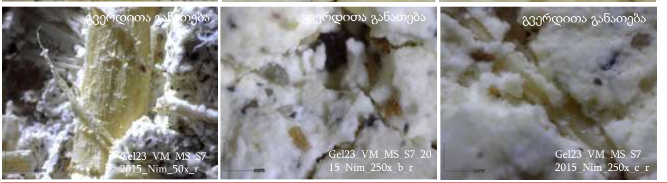
ზემოთ: საიდუმლო სერობის მაკრო ფოტოები საფუძვლის (0) ნალესობის ქვედა (1) და ზედა (2) ფენების მითითებით. მარცხნივ: მიკროსკოპული ფოტოები ნალესობის შემკვრელში შერეული არაორგანული აგრეგატული მინარევებითა და ორგანული, მცენარეული ნამჯის მსგავსი ჩალისფერი ჩანარებით.
