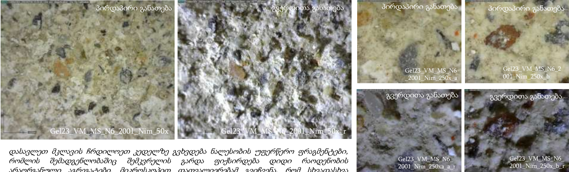
ზემოთ: დასავლეთი მკლავის ჩრდილოეთი კედელი (N6). ქვემოთ: მიკრო ფოტოები, უფერწერო ნალესობის არაორგანული აგრეგატული ჩანარებით.
