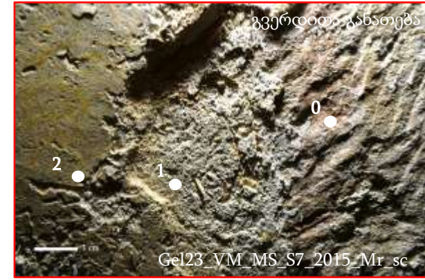
ზემოთ: საიდუმლო სერობის მაკრო ფოტოები საფუძვლის (0) ნალესობის ქვედა (1) და ზედა (2) ფენების მითითებით. მარცხნივ: მიკროსკოპული ფოტოები ნალესობის შემკვრელში შერეული არაორგანული აგრეგატული მინარევებითა და ორგანული, მცენარეული ნამჯის მსგავსი ჩალისფერი ჩანარებით.
