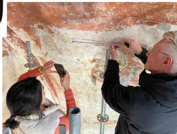
მარჯვენა: Topdon კამერის გამოყენება მხატვრობის ზედაპირის ტემპერატურის განსასაზღვრად.
