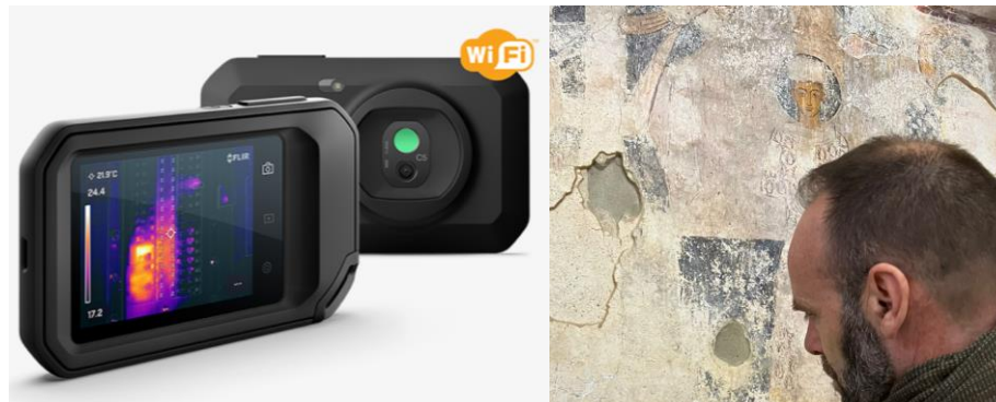
მარჯვენა: Flir კამერის გამოყენება მხატვრობის ზედაპირის ტემპერატურის განსასაზღვრად.
