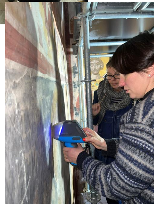
მარჯვნივ: პორტატული XRF-ის გამოყენების პროცესი. შარავანდედის ფერწერული ფენის ელემენტების შესწავლა.
