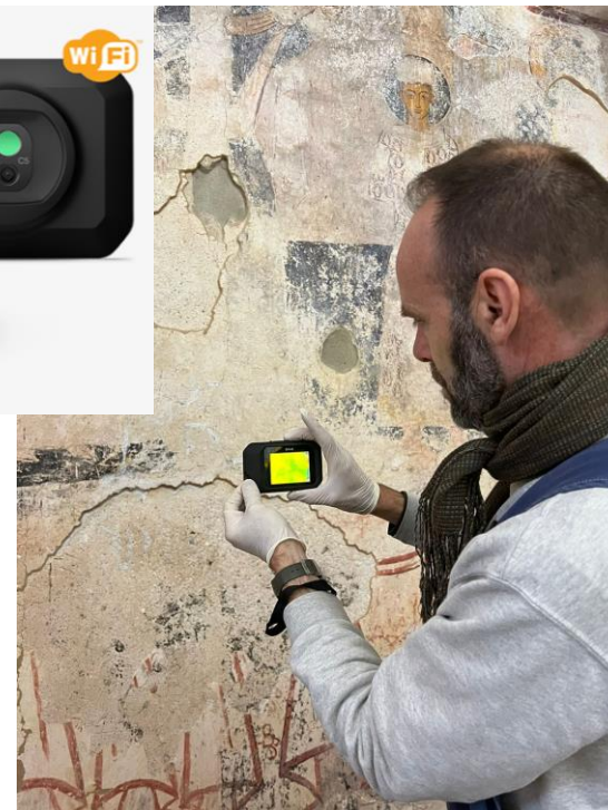
მარჯვენა: Flir კამერის გამოყენება მხატვრობის ზედაპირის ტემპერატურის განსასაზღვრად.
