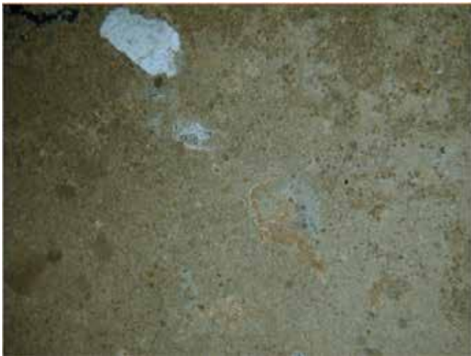
7. ფოტოზე - კირის გუნდები და იშვიათად შემჩნეული შემავსებელი ნაწილაკები, რომლებიც ფორიანობით ხასიათდებიან MPOM ფოტომიკროგრაფი, გადაღებული გამტარ სინათლეში, ნიმუშის თხელ ნაჭერზე 80 x N+.
