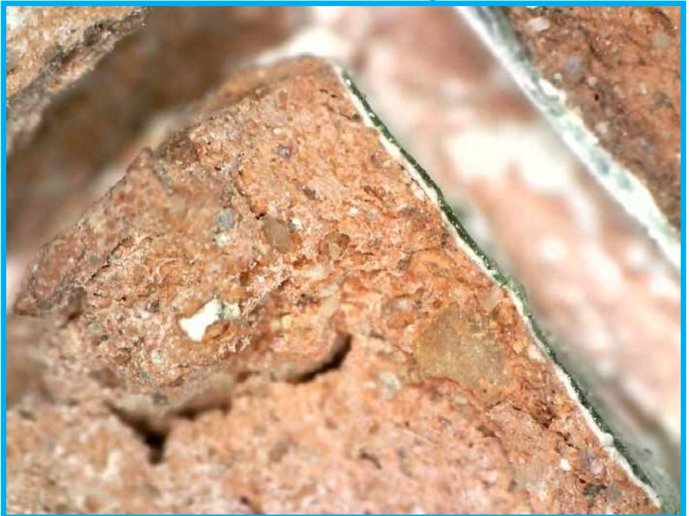
36. ტერაკოტის ტესერას დეტალი გადაღებული დინოლაითის მიკროსკოპით
