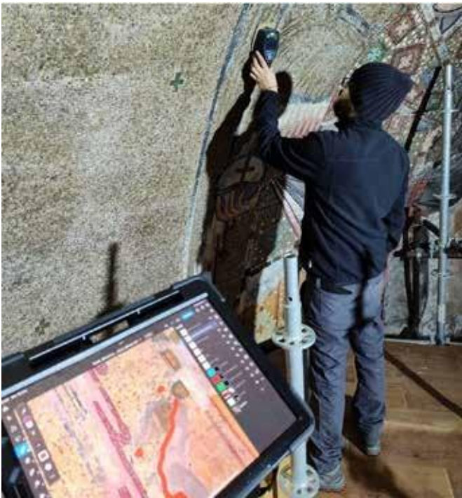
34-35. გეორადარული კვლევა განხორციელდა შერჩევითი (მიზნობრივი) მეთოდით და არ გამოყენებიათ ფართო მასშტაბით დაფარვის სტრატეგია.
