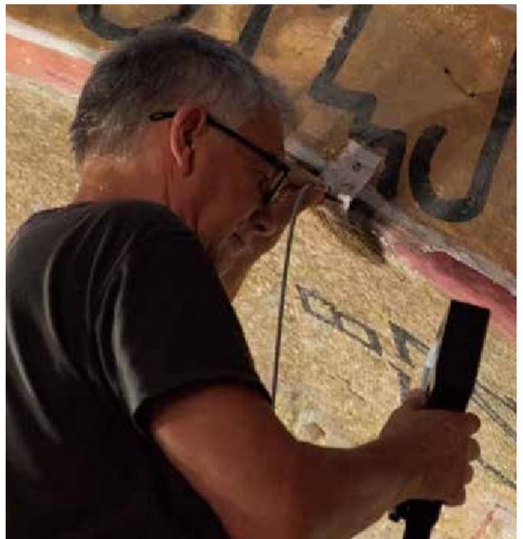
29-30. იმისათვის, რომ გამოგვეკვლია მოზაიკის უკან არსებული ცარიელი სივრცე, ვიდეო ბოროსკოპი იქნა გამოყენებული.
