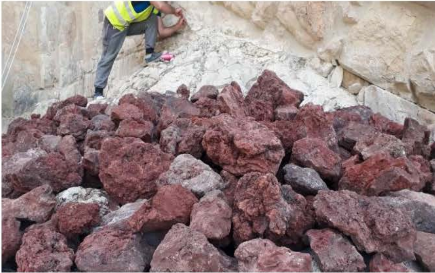
ფოტო: ეკვდერის გადახურვა, ბურულქვეშა სივრცის მსუბუქი შემავსებლით შევსება
